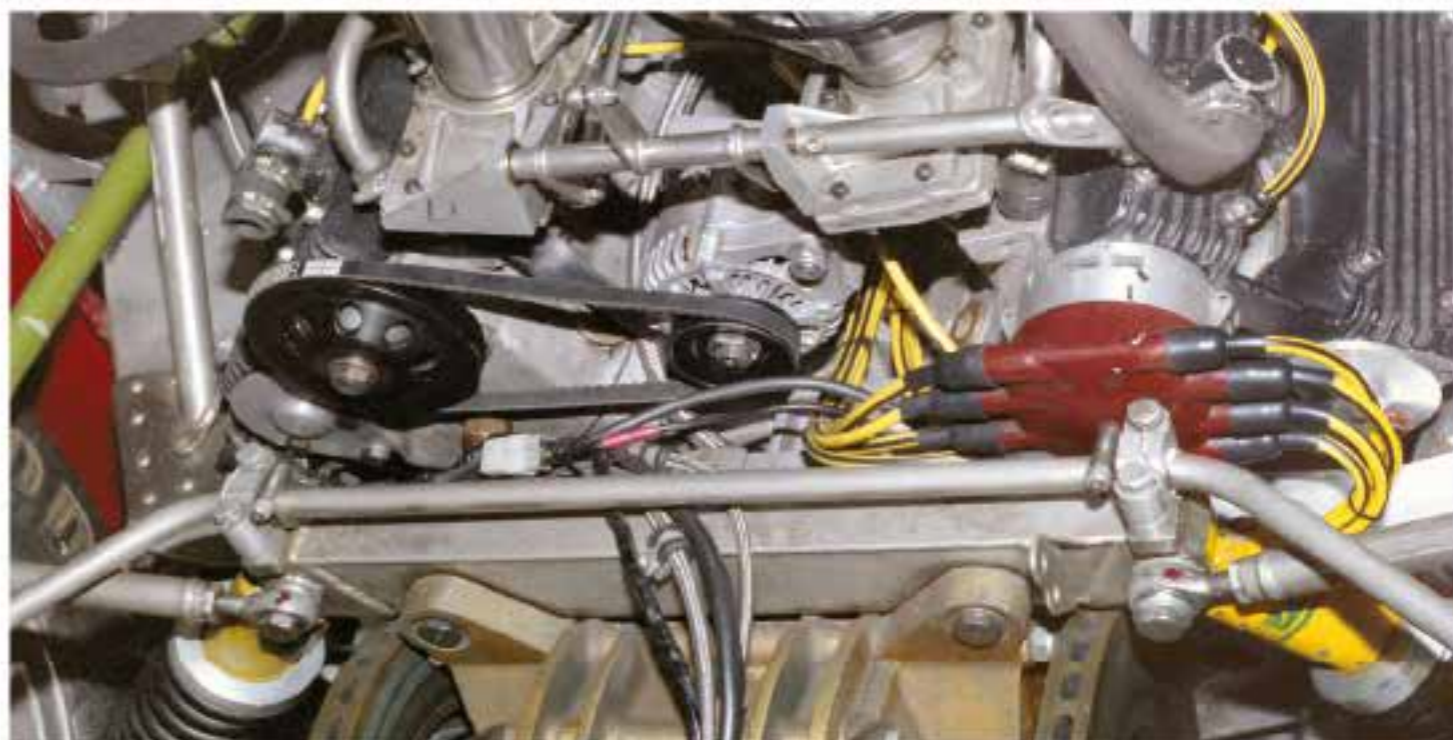
Hieronder: de nieuwe alternator op zijn knusse plaats en op de rechterpagina gereed voor gebruik.
