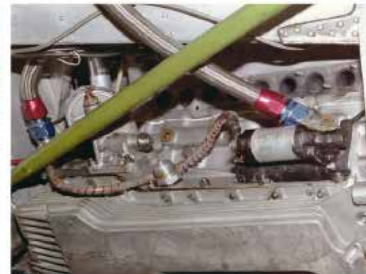
Het carter bij ingebouwde motor verwijderen lukte niet.
