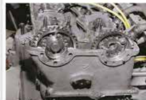
Onder: de tandwielen aan de nokkenassen en de achterzijde van de cilinderkop.
