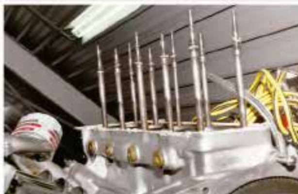
Boven: de cilinderkop verwijderd en onder de verbrandingskamers.
