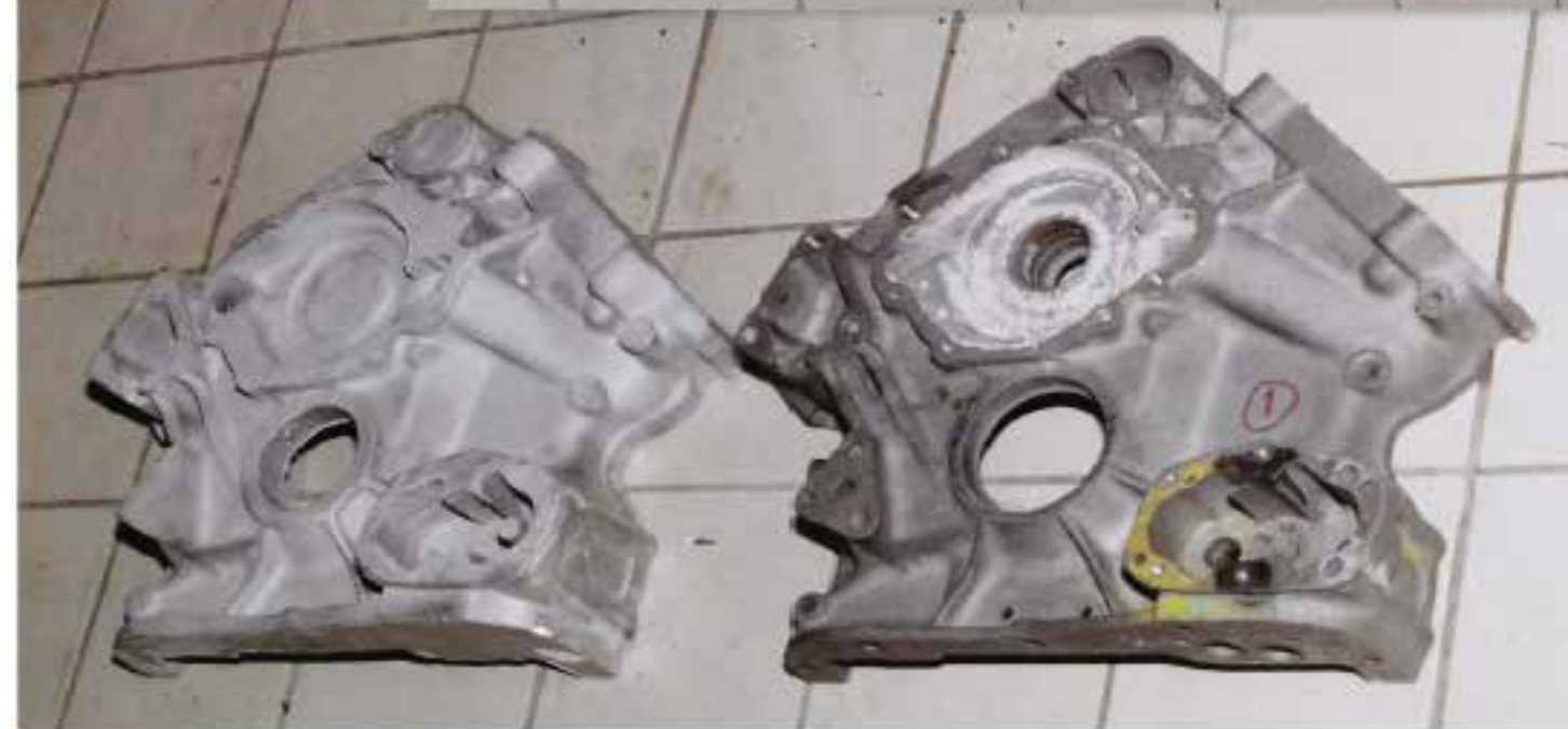
Boven foto's van het oude en nieuwe deksel en hieronder het aanpassen van het nieuwe exemplaar op de motor.
