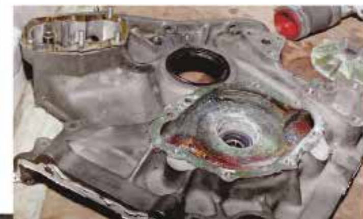
Rechts: de waterpomp in het distributiedeksel.
